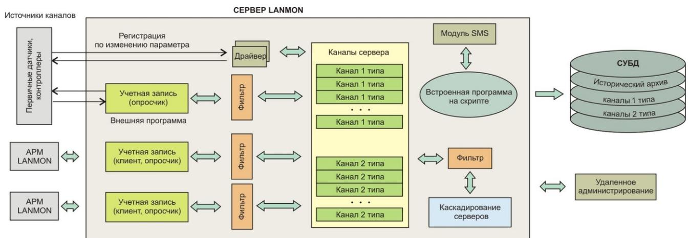
Рисунок 1 - Структурная схема сервера LanMon
